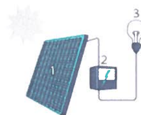
1. Zonnepaneel | 2. Omvormer | 3. Elektrische toestellen
